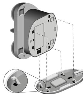
Den iTalk<sub>2</sub> auf der Bodenplatte befestigen:
