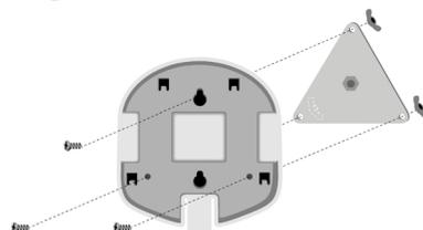
Verbinden Sie dazu die Bodenplatte mittels Schrauben und Flügelmutter mit der Befestigungsplatte und befestigen Sie diese am Halterungsarm.
