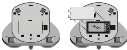
Schließen Sie das Batteriefach anschließend wieder.
